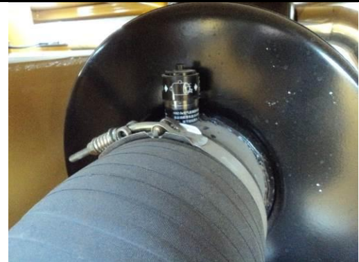
Воздухоочиститель расположен под капотом на левой стороне машины.
