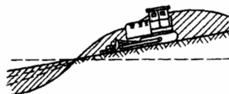
Бульдозерные работы под уклоном
